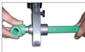
Caliente simultáneamente toda la profundidad del tubo y el extremo del accesorio con el polifuso, ejerciendo una ligera presión.
