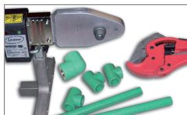
La unión de tubos y accesorios se efectuará a través de una soldadura de polidifusión a 260°, con equipo adecuado suministrado por Heliroma.
