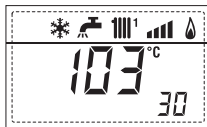
31. Visualización valor de la temperatura de la sonda solar S2 con tarjeta SOLAR
