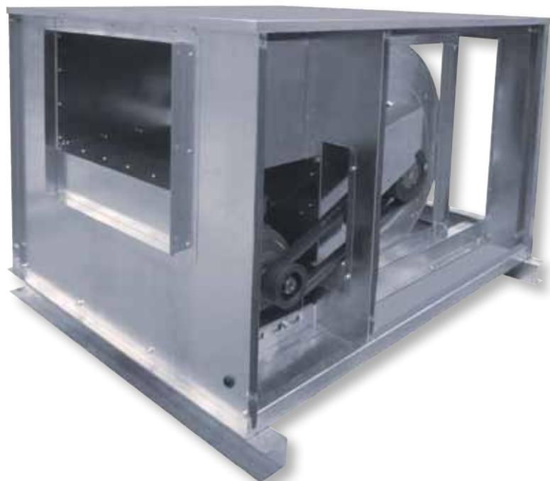
Cajas de ventilación a transmisión, desenfumage, capacitadas para trasegar aire a 400°C/2h, fabricadas en chapa de acero galvanizada, ventilador centrífugo de álabes hacia adelante, accionado a transmisión por un motor incorporado en el interior, IP55, Clase F.
