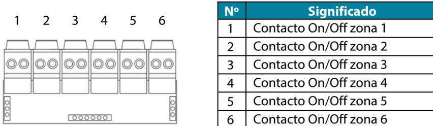
**Nota:** Al abrir el contacto de una zona, se cierran los elementos controlados en esa zona, a los 60 segundos, y el termostato indica con un mensaje la apertura de esta entrada (Fig. 14).
