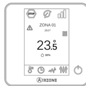
Para sustituir la batería, separe el termostato de su soporte y sustituya la batería (CR2450) (Fig. 27).
