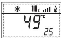
26. Visualización termostato de seguridad con tarjeta ZONA MIX 2 (entrada S1) respectivamente ON y OFF
