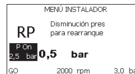
Figura 17: Configuración de la presión de reencendido
